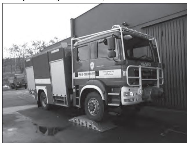
Obr. 4: Zkouška mezinápravové průchodnosti
