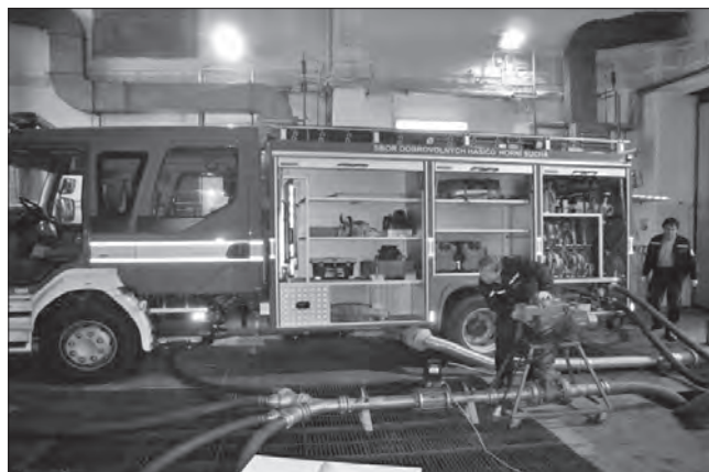
Obr. 6: Provozní zkouška čerpadla cisternové automobilové stříkačky
