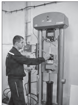
Obr. 2: Stanovení soudržnosti vrstev tlakové požární hadice
