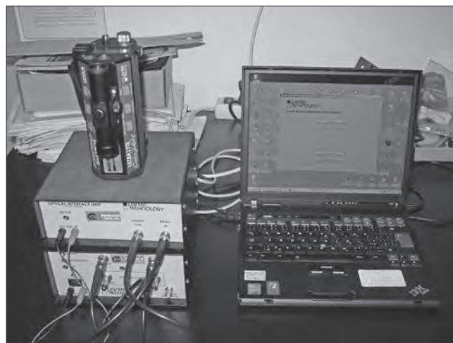
Ověřování lidarového rychloměru na simulátoru, ČMI
