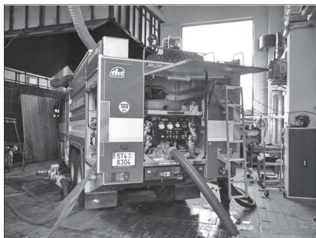
Obr. 5: Funkční zkouška užití hasicího média CO 2 u kombinovaného hasicího automobilu
