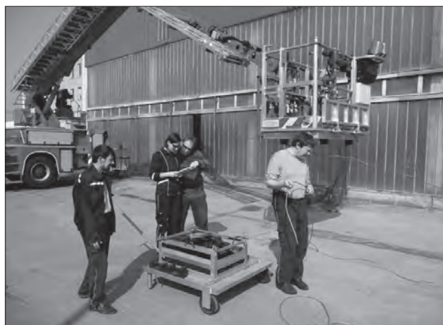
Obr. 7: Zátěžová a funkční zkouška automobilové plošiny
